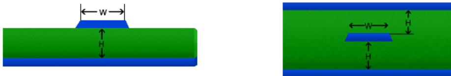
Figura 6: (esq.) Microstrip - (dir.) Stripline Fonte: Saturn PCB Design
